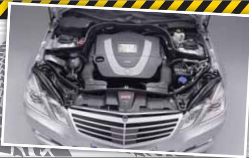
و باش سوخت مستقیم داخل سیلندرها مجهز است. بر این اساس موتور M272 KE35 می‌تواند حداکثر ۳۰۰ اسب بخار قدرت را در ۶۰۰ دور (دور در دقیقه) و حداکثر ۳۵۰ نیوتن متر گشتاور را در ۵۰۰ آربی ام فراهم کند. این موتور با کد M272 KE35 روی مرسدس بنز E350 W212 نصب شده است. این موتور در میان اسپرت دوستان سیاه محبوب گشتاور الاینی برخودار است. این موتور در میان اسپرت دوستان سیاه محبوب است: جواکه دارای ساختار تمام الامونیوم با مکانیزم اتمسفریک است. این پیشرانه همچنین به تکنولوژی متغیر هوشمند سوپاپها
