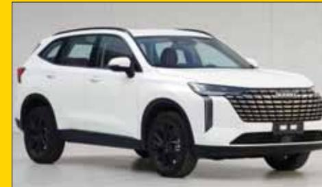
از سیستم پلاگین-هیبرید Hi4 موتور گریت‌وال (GWM) نامین می‌شود. در حال حاضر، MiIT چین یک پیش‌رانه ۵ لیتری تنفس طبیعی مدل (GW4B15H) با حداقل قدرت ۸۵ کیلووات (۱۱۰ اسبیخار) و یک مجموعه باتری فسفات‌اهن-لیتیوم از کمپانی SVOLT را اعلام کرده است. طرفیت پاتری، بردو مشخصات موتورهای کتریکی هنوز گفته نشده است. حداقل سرعت این خودرو ۱۸۰ کیلومتر بر ساعت است. علاوه بر این، هاول H6 پلاگین-هیبرید Hi4 جدیدترین T19/55 استفاده می‌کند.
