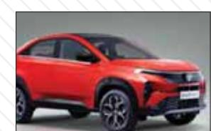
در بازار چین عرضه خواهد شد. قوای محركه پلاگین هیبرید فالوین ۱۰ تازیک پیشرانه ۱۵ لیتری ۴ سیلندر توربو تشکیل شده است که به تنها ۱۵۴ اسپ بخار قادرست و ۲۲۰ نیوتون متر گشتاور تولیدیم کند.
