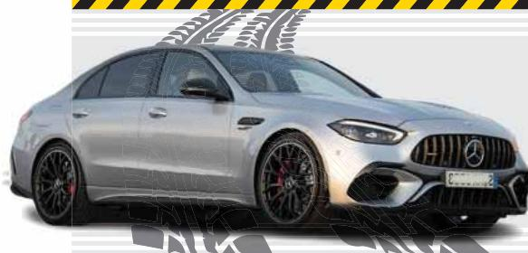
به فناوری بای-توربو و پاشش سوخت مستقیم داخل سیلندر تشکیل می‌دهد که در همانگی باموتورهای الکتریکی و ساختار پلاگین-هیبرید PHEV می‌تواند حداقل ۶۰٪ اسپیخار قدرت را صورت ترکیبی و حداقل ۱۰٪ نیوتن متر گشتاور را به صورت ترکیبی به جرخ هایراند. برای اساس و با همانگی گیریکس ۹ سرعته جی ترونیک اسپیدیشن، این مرسدس بنز تها طرف ۴۷ تا بیان حالت سکون پسرعت ۱۰۰ کیلومتر بر ساعت دست می‌یابد. مرسدس بنز C63 S E-Performance دارای تکنولوژی کیلوتر پیک بوده که به عنوان قوی ترین سدان ۴ سیلندر جهان نیز شناخته می‌شود.
