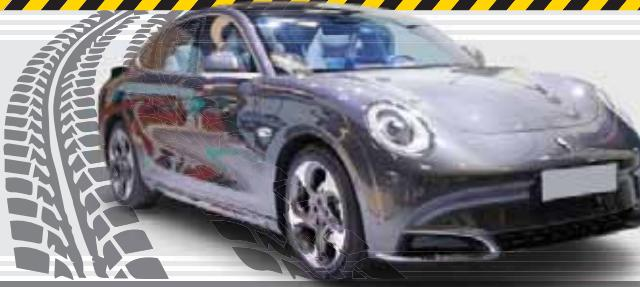
قوای محرك و مشخصات کاملاً يکسانی دارند و تغییرات ۲ کت فقط شامل دیگری های داخلی و خارجی می شوند؛ بنابراین این مدل ها هردو به یک موتور الکتریکی با ۱۷۱ اسب بخار قدرت ۲۰ و ۲۵ نیوتن متر گشتاور مجهز هستند که این تبرو جرخ های چلو منطبق می شود. برای تأمین انرژی این موتور باتری های ۴۸ و ۶۳ کیلووات ساعتی قابل انتخاب خواهد بود که به ترتیب پسرد ۳۰۰ و ۴۰۰ کیلومتری رفاه امامی کنند. ۱ کت در ۸.۵ ثانیه از صفر به سرعت صد کیلومتر بر ساعت می رسدو توپانی دستیابی به حد اکثر سرعت ۱۶۰ کیلومتر بر ساعت را دارد.
