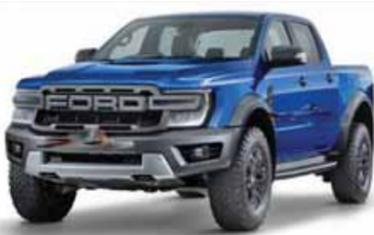
خودرو است و برای همین موتور ۳.۰ لیتری V6 بنزینی را برای آن در نظر گرفته است. این موتور ۳۰۰ کیلوواتی می‌تواند فاصله ایجاد شده بین موتورهای ۲.۰ و ۳.۵ لیتری ۳۳۵ کیلوواتی را پر کند. گمان می‌رود با نصب این موتور و همچنین تغییرات ایرودینامیک بدنه، نه تنها سرعت رپتور که شتاب صفر تا صد آن نیز از ۱۰.۲ ثانیه فعلی بهتر شود. شاید این تغییر موتور بتواند ضعف شتابی رپتور در مقابل فولکس واگن آمارو که راجبران کند. هنوز مشخص نیست موتور جدید در چه بازارهایی عرضه خواهد شد.
